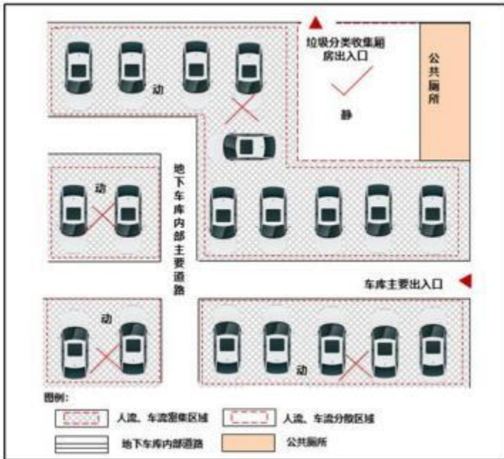
图 5.3 垃圾分类收集厢房设置示意图
