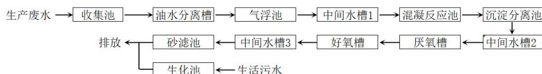
图 4.2-1 厂区污水处理设施工艺流程图
