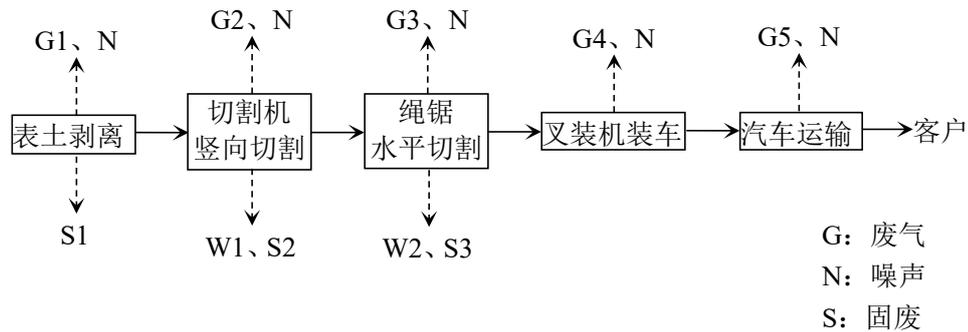
图 4.1 拟建项目开采工艺及产污环节图
