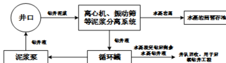
图 5.1-1 本项目钻井过程中钻井液循环方式
