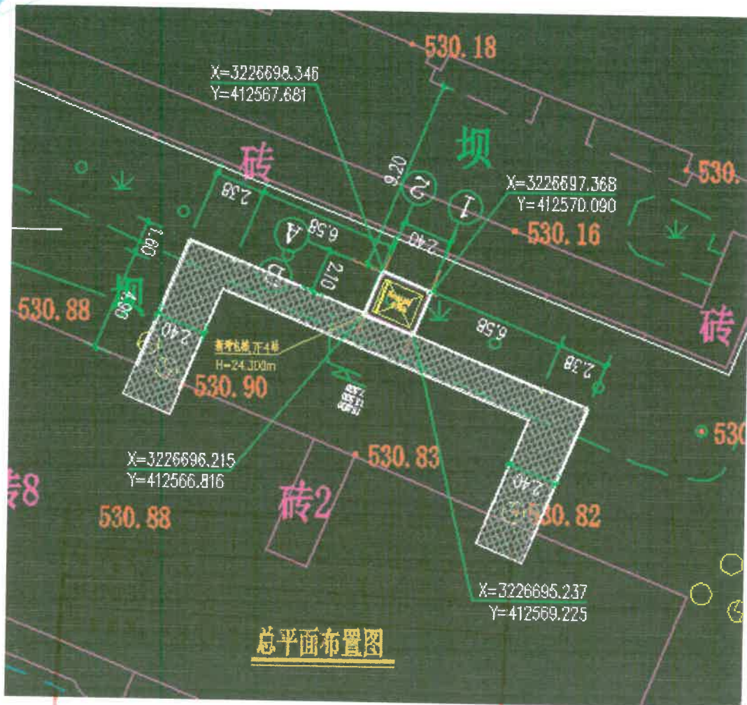
图 3.1 增设电梯一层平面布置
